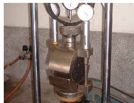
品質試験（マーシャル安定度試験）
