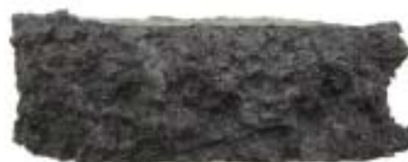
写真 エコフィックスを用いた混合物の水浸ホイールトラッキング試験後供試体 (剥離率 0%)
