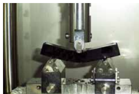
写真 バインダーの曲げ試験状況
